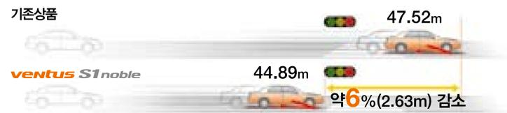
\* 테스트 조건 · 규격 : 225/50ZR17 · 차량 : NF-Sonata · 속도 : 100km/h · 수심 : 1mm
